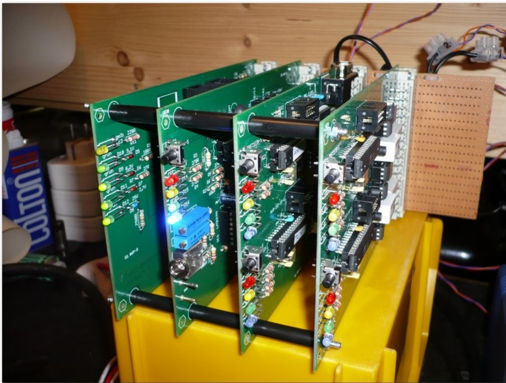
Abbildung 1: Musteraufbau des TelexPhone 2 mit Busplatine
